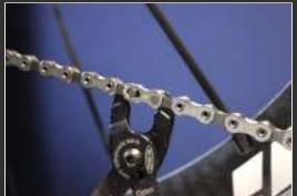
**7.** Votre dérailleur est maintenant prêt à être remonté et à recevoir sa nouvelle chaîne. Il faut pour cela mettre mettre le petit pignon et le petit plateau. La tension de la chaîne doit être minimale.
