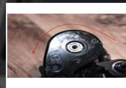
**6. A cette étape il faudra faire une rotation dans le sens anti horaire de la chape et venir positionner la partie plate de la chape et la partie plate du dérailleur l'un en face de l'autre, vous pourrez à ce moment là visser l'écrou complètement puis mettre la vis de butée de la chape puis remonter la chape entièrement avec ses galets et sa plaque de carbone arrière.**
