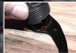
**5. Insérez le ressort d'origine dans le dérailleur SRAM, puis l'autre partie dans le percage de la chape CyclingCeramic puis positionner la chape dans la vis centrale du dérailleur. Mettez l'écrou SRAM et vissez sur un filet uniquement**
