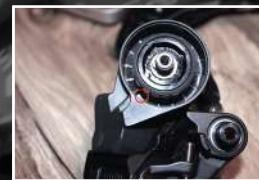
**4. Démonter la chape CyclingCeramic en enlevant les vis des galets et de la butée. Puis Veuillez indiquer à l'aider d'un feutre la partie plate de la plaque CyclingCeramic et de la vis du dérailleur Sram afin de faciliter son montage.**
