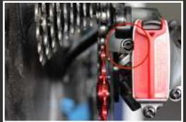
**13.** Remettre une chaîne sans dans sa longueur d'origine, petit pignon-petit plateau. Ajuster avec la vis de tension votre chaîne jusqu'à avoir l'axe de votre roue en face de l'axe de la vis du bas de votre cage.
