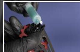
7. Graissez l'embout du pivot et enlevez la butée en place sur votre ODC CyclingCeramic.
